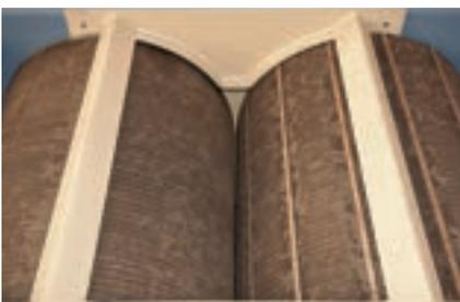
Hartauftragsgeschweißte Standardwalzen zum Zerkleinern von Hohlglascherben. Eine Walze ist zusätzlich mit Querschweisraupen für eine bessere Zuführung des Eingangsmaterials versehen.
