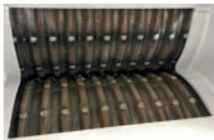
Hartgeschweißte und gerillte Walzen für die Flach- und Hohlglaszerkleinerung.
