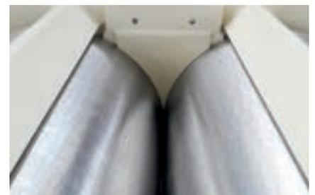
Hartauftragsgeschweißte und geschliffene Walzen für die Feinkornproduktion.
